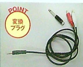
会場の機器の出力がどんな端子かわからない場合は、ピンプラグ、ミニプラグ、標準プラグの3種類に接続できるよう変換プラグなどを用意しておくと、大抵のケースに対応できる。
