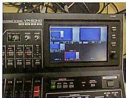
VR-50HDには複数のカメラとマイク音声が集められ、流れに合わせて適宜スイッチングされる。タッチスクリーン操作の機器なども導入されてはいるが、複数の、専門家以外も含めた人がオペレーションするにあたっては「物理的なスイッチ」の存在が、わかりやすさの面からひじょうに大きいとのこと。VR-50HDはパネル上のスイッチやスライダー類でほとんどの主要な操作が行えるので、映像機器に関する少々の知識があれば初見でもマニュアルなしで基本的な操作が充分に可能だ。ハード性能以外に、そうしたユーザーフレンドリーの側面でハードウェアの存在意義はまだまだ大きい。
