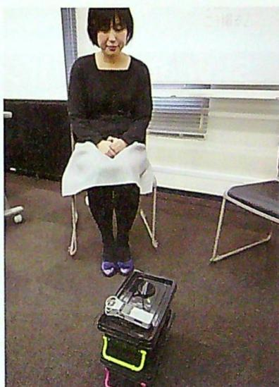
テーブルや床などの平面に設置できる「バウンダリーマイク」(写真はオーディオテクニカ「AT9921」)は、全指向性(無指向性)になると放射状にバランスよく音を拾ってくれるので、テーブルを囲んでの座談会なども収録しやすい。上の写真のように椅子だけの場合でも(床の振動を避けるため)適当な台などに置いて出演者の足元付近まで近寄って収録すればよい。
