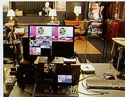
配信システムの横には、配信用のパソコンとは別に素材出し専用のMac miniが置かれ、HDMI経由でVR-50HDに接続されてスライドなどの素材出しに使われている。たとえば社内で余っている数年前のパソコンなどでも、こうした素材出し用途には充分使える場合が多く、安定性も含めて素材出し専用のマシンを置く意味は大きい。
