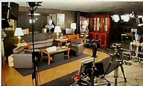
カメラは合計3台で、基本的に1人のカメラ担当者がオペレート。メインカメラはザハトラー製の小型ペデスタルに設置されている。照明は、海外の映像コンテンツによく見られる色合いを目指し、試行錯誤してセットしているそうだ。
