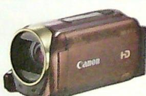
キヤノンiVIS HF R52のように、高画質なAVCHDと、ファイル容量の軽いMP4を同時に録画できるビデオカメラは増えている。後の編集用に高画質なファイルを残しつつ、パソコンでのエンコードなどを行わずにモバイル環境用に軽いファイルのアップロードが可能となる。
