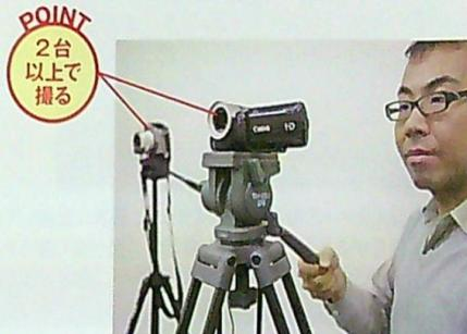
特に一般的な観客が入るタイプのセミナーは予想外の出来事が頻繁に発生するので、カメラのトラブルも考慮して「人が操作するメインカメラ」と「固定のサブカメラ」の2台以上で撮影するのが望ましい。AC電源を接続している場合は、線が抜けた場合に配慮し別々のコンセントから電源をとるのがベターだ。
