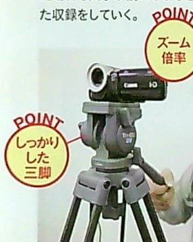
メインカメラのズーム映像は、倍率さえあれば比較的安価なカメラでも必要十分な見栄えのする映像を撮りやすい。むしろ、操作感の良いビデオ三脚でなめらかなカメラワークを行なったほうが品質に直結るので、カメラをワンランク落としてでもしっかりと三脚を準備することをオススメする。
