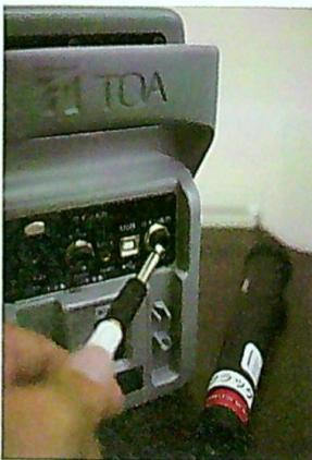
会場内の拡声を担う音響機器には多くの場合、音声の出力があるので、そこにラインで接続して音声を収録するのも良い方法である。ピンマイクはほぼ装着者の音声しか拾えないのに対し、この方法ならマイクで発言した声をすべて明瞭に録音できるというメリットがある。
