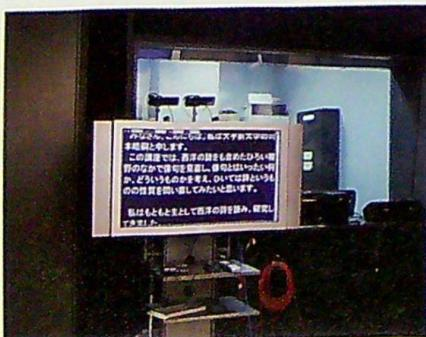
カメラのすぐ下に置かれたモニター上に原稿が表示されることで、自然な目線をキープしながら、原稿を読んでの着実な収録が可能となっている。原稿は調整室からの操作でスクロールできる。
