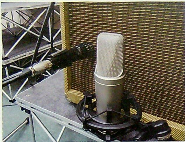
▲この日はギター系商品の収録だったので、ギター・アンプにもマイクが立てられていた。写真右側がコンデンサーマイクのRODE NT2000、左側がダイナミックマイクのAUDIX i5で、いずれもサウンドハウスが日本代理店となっている。両方ともサウンドの傾向がまったく異なるので、マルチマイク収録すると状況に合わせてより最適なソースを選択することができる。
