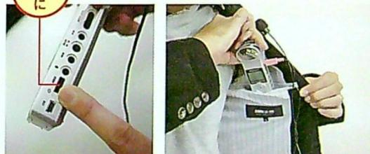
PCMレコーダーは録音中にモニターできないという弱点があるので、事前に充分テストした上で、録音状態で「HOLD」にして何かのタイミングで停止してしまうのを防いでおくとより安心。
