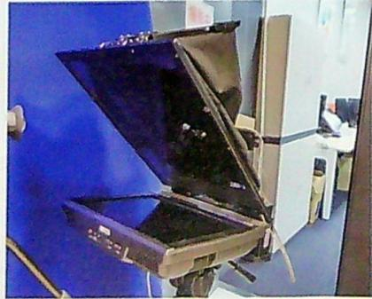
別途用意されていた可搬式のプロンプター。カメラと組み合せると、モニターの向こうから完全にカメラ目線での収録ができるので、正確な文言が求められる収録にはひじょうに重宝する。
