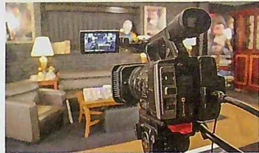
メインカメラはソニーの4Kカメラ「FDR-AX1」を使用。配信では現在最高でも720pの解像度だが、将来的に発展した使用の余地も考えてチョイスしたこと。買い直しは結局高コストになる場合も多いので、こうした将来を見据えた選定を有効に行ないたい。
